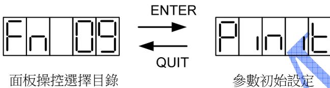
在完成"參數初始設定"後，使用者還需進行一個步驟。便是"電流Sensor校正"。由於因為原廠測試環境與使用者工作環境未必能完全相符。故使用者可以自行透過此項功能來進行電流Sensor的微調。使工作效率能更高更快速。此功能與FN09操作相同，使用者必須先以FN 10功能解除系統閉鎖狀態，才能執行本功能。
