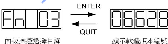
在"面板操控選擇目錄"顯示"FN 03"時按下ENTER鍵，即可進入"顯示軟體版本編號"功能(顯示畫面如左)。
