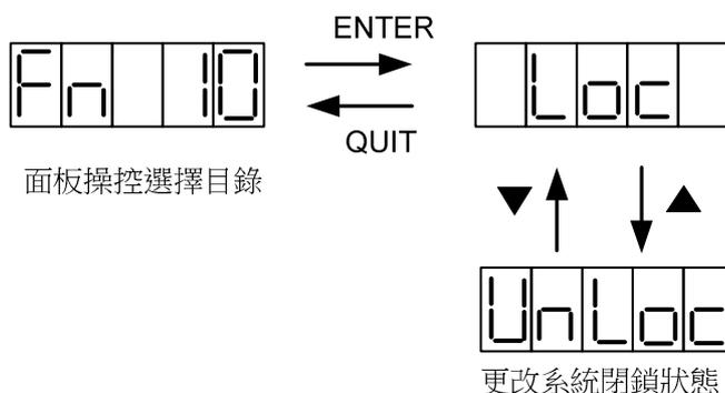
使用者可藉▼▲鍵來更改閉鎖"Loc"或解除閉鎖"UnLoc"，再按ENTER鍵確認即可完成更改，回到"面板操控選擇目錄"。若按下QUIT鍵，即可放棄之前所做修改，以原來狀態回到"面板操控選擇目錄"。
