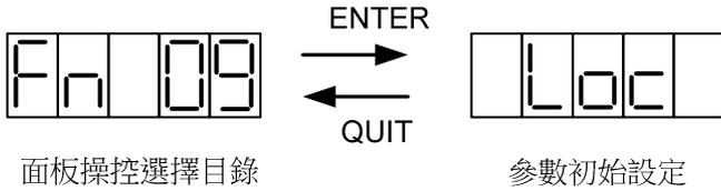
"參數初始設定"會將CSBL700所有系統參數重設成出廠時的預設值。一旦執行就不易回復，為防止使用者在不注意的情況下誤用此功能，CSBL700有多一道防護機制。使用者必須先以FN 10功能解除系統閉鎖狀態，才能執行本功能。
