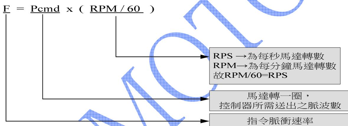
範例 A：若編碼器規格為（解析度 500P/R）參數 PN12、PN13 設定為 1 時，要使馬達轉速到達 3000RPM，則控制器所需送出指令脈衝速率為何？
