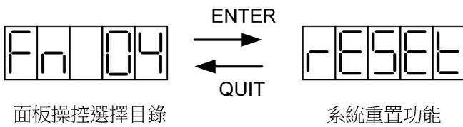
在"面板操控選擇目錄"顯示"FN 04"時按下ENTER鍵，即會執行"系統重置"功能（顯示畫面如左）。系統重置 (Reset) 會重新啟動CSBL700，效果大致等同關機後再重新開機。
