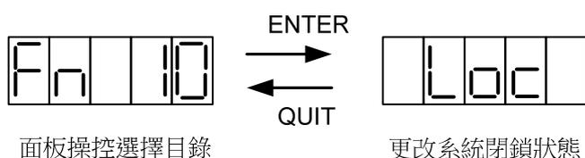
在"面板操控選擇目錄"顯示"FN 10"時按下ENTER鍵，即可進入"更改系統閉鎖狀態"功能。此時CSBL700會將系統目前閉鎖狀態，"Loc"或"UnLoc"顯示在LED上（顯示畫面如左）。
