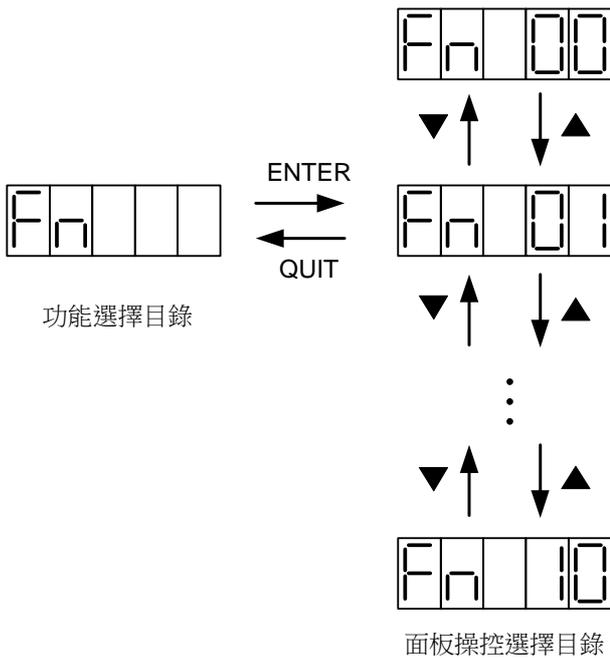
面板操控功能是讓使用者在進行系統微調或馬達測試時，能夠透過面板操作，即可完成所有必要的動作。各種操控功能的詳細內容及操作，請參考附表。
